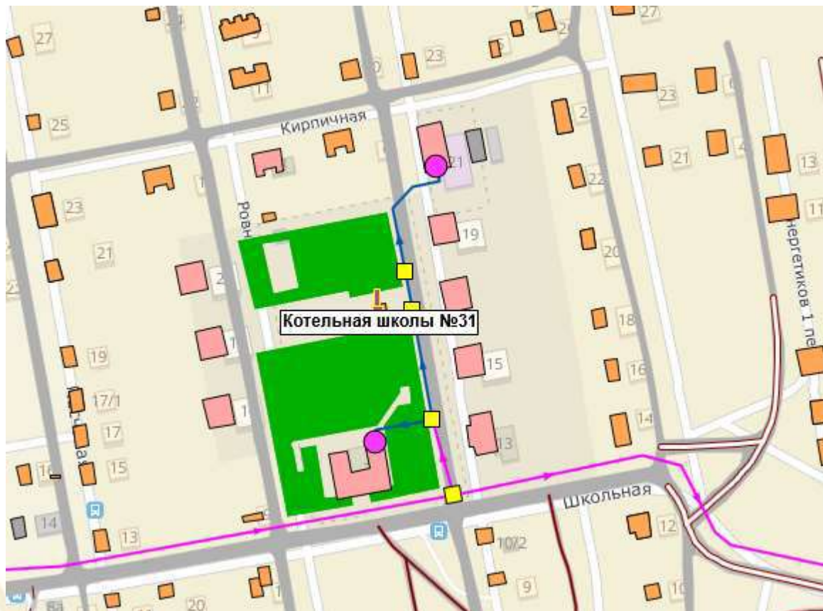
Рисунок 13. Организация теплоснабжения потребителей котельной школы №31
